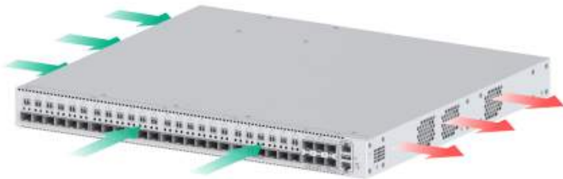
图5-1 设备散热空气流向示意图（以 FS5300-24UXS6X-EI 为例）
