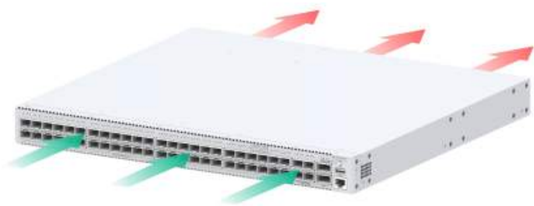
图5-2 可插拔风扇机型散热空气流向示意图（以 FS5500-48UXS4Y2Q-EI 为例）
