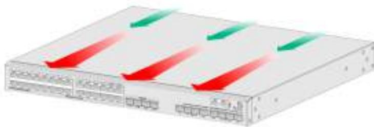
图5-2 LSPM1FANSB-SN 风扇散热空气流向示意图（以 S5590-28P8XC-EI 为例）
