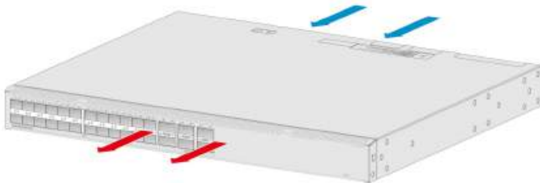
图5-2 交换机散热空气流向示意图二（以 S6520X-30HF-EI 安装 LSPM1FANSA-SN 为例）
