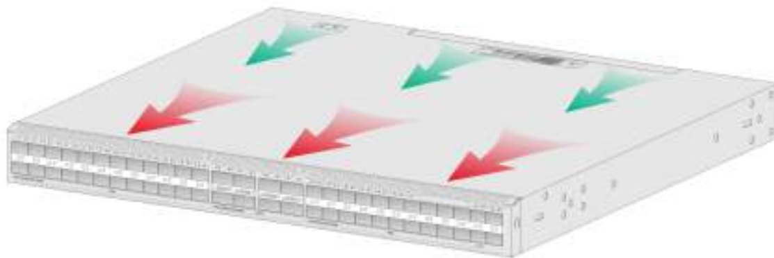
图5-1 可插拔风扇机型散热空气流向示意图（以 S6530X-48Y8C 安装 LSPM1FANSA-SN 为例）
