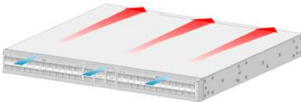
图5-2 端口侧进入电源侧排出散热空气流向示意图 (以选配 LSPM1FANSB 为例)
