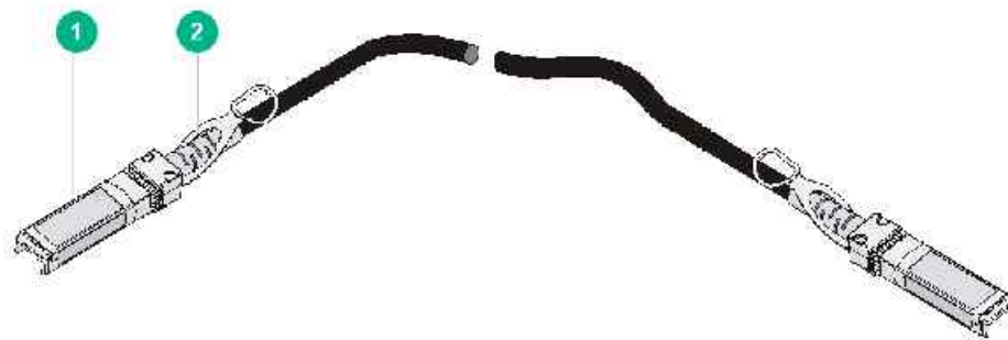
图4-6 SFP+ DAC 电缆示意图
