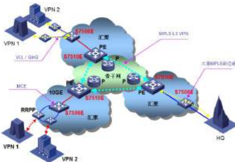
图 2 H3C S7500E 在 MPLS 组网中的典型应用
