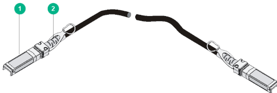
图4-5 SFP+DAC 电缆示意图
