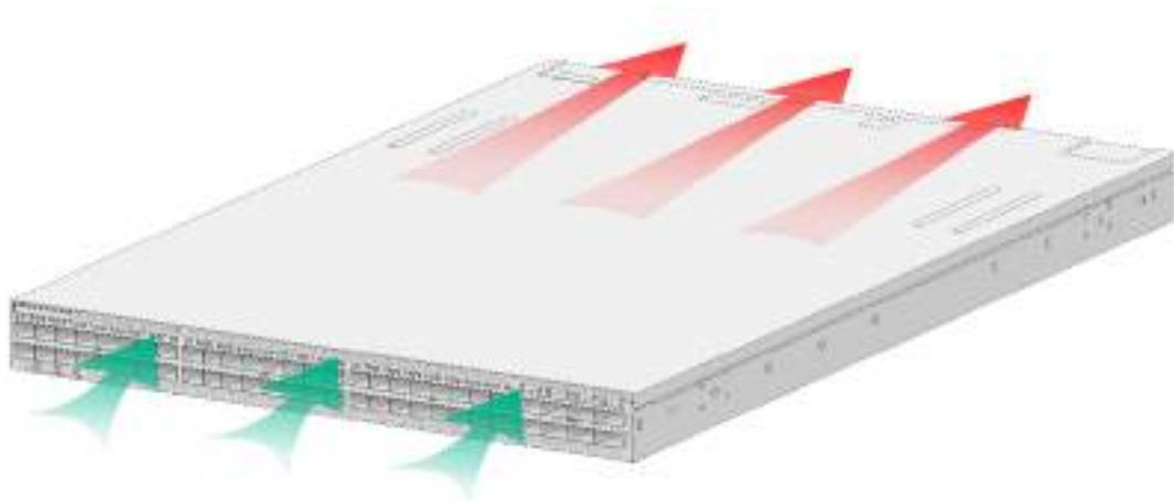
图5-4 S9855-24B8D 端口侧进入电源侧排出散热空气流向示意图
