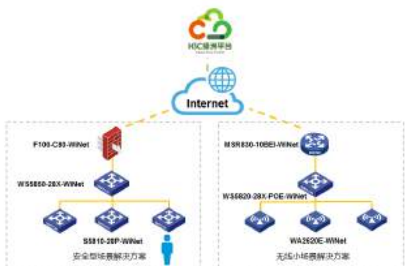
WS5810-WiNet 接入交换机应用示意图
