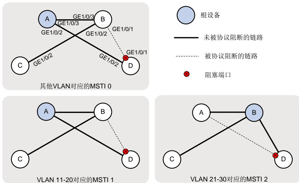
可以看到，Device C 在 MSTI 0~1 中的上行链路所在端口已从原先的 GigabitEthernet1/0/1 切换为 GigabitEthernet1/0/2。
