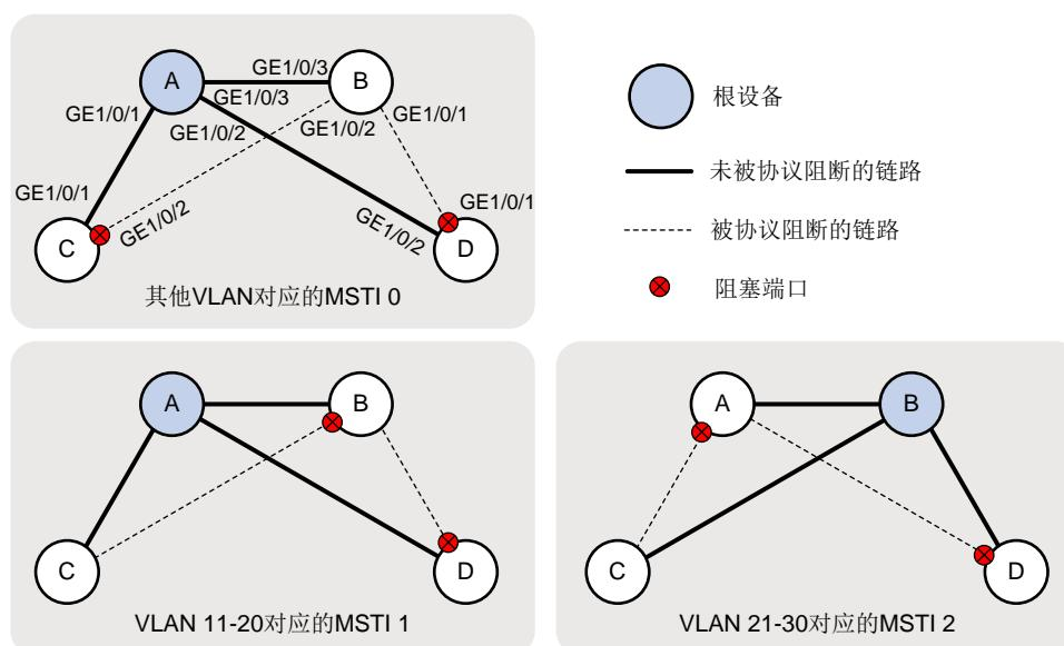
可以看到，Device C 和 Device D 的 VLAN 11~20 报文和 VLAN 21~30 报文沿不同的上行链路转发；网络中无二层环路。
