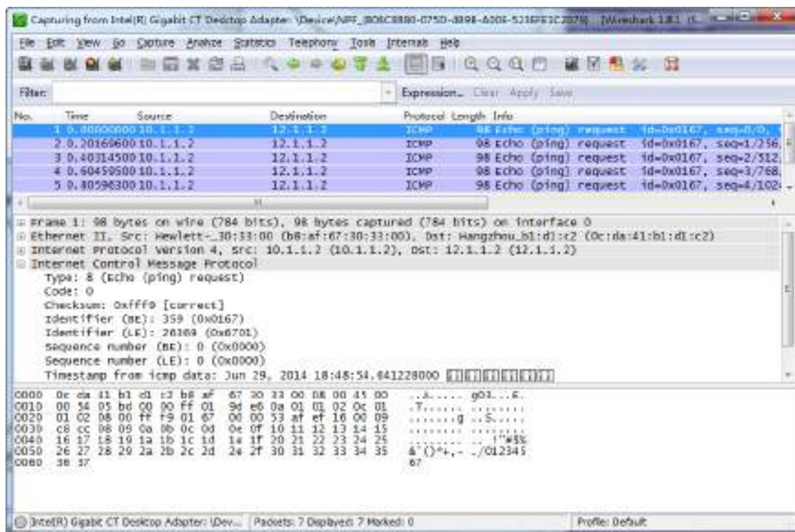
以上抓包信息表明，配置的二层远程端口镜像功能生效，数据监测设备可以成功对研发部发送的报文进行监控。
